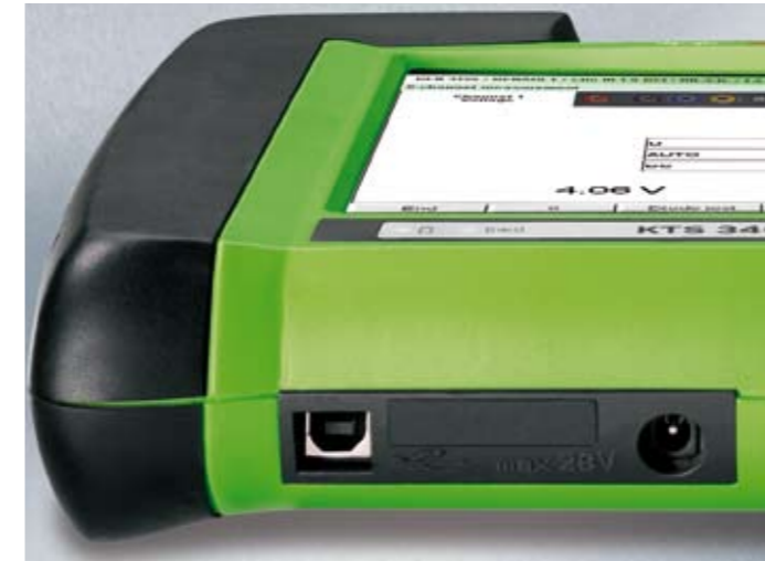
Collegamenti: USB per PC e stampante, slot scheda PCMCIA e alimentazione
